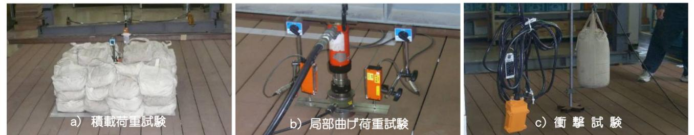
◆ K-1デッキは、『積載荷重 500kg 局部曲げ荷重試験 300kg』時においての安全を確認しております。
