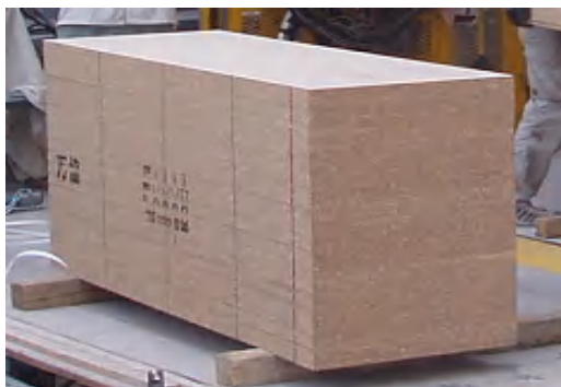
パーティクルt=20 2×6 23N F-☆☆☆☆ 50枚梱包 16.5kg/枚
