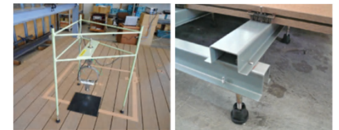
[ 転倒衝突時 硬さ試験 及び 下地断面 ]
