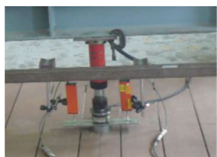
【共通：局部曲げ荷重試験】 【共通：転倒衝突時の硬さ試験】
