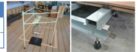
【転倒衝突時 硬さ試験 及び 下地断面】
