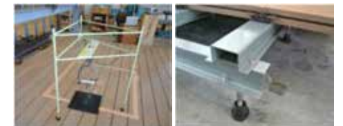
[ 転倒衝突時 硬さ試験 及び 下地断面 ]
