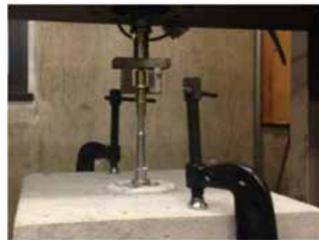
c) 荷重試験機による試験状況
